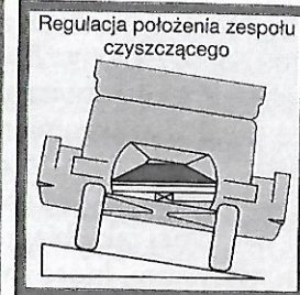
Rys. 2.234. Schemat automatycznego poziomowania zespołu czyszczącego
